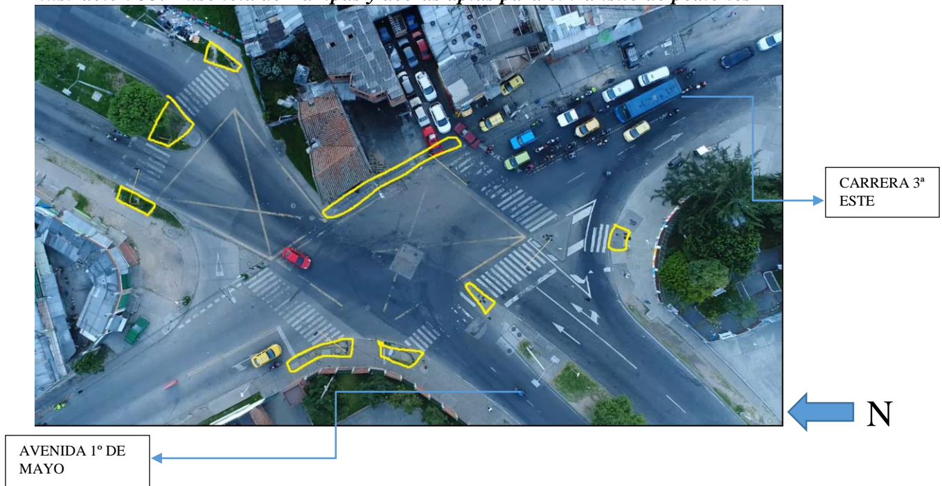
Ilustración 33. Falta de rampas peatonales. Elaboración propia
