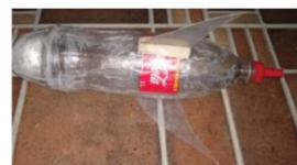
Figura 4. Cohete con alerones, punta y boquilla acoplados y la base de lanzamiento a 45°. Autor propio.
