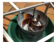
Imagen 2. Prototipo de Turbina (Álabes y Eje)
