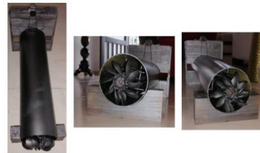
Figura 2. Prototipo construido de turbina de río horizontal.
