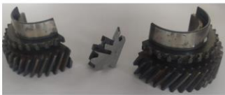
Figura 2. Corte del piñón helicoidal de una caja de la transmisión de un vehículo.
