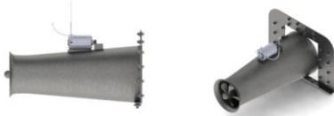
Figura 1. Diseño culminado del prototipo de turbina horizontal en SolidWorks.
