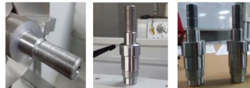
Figura 2. Torneo, paso de rosca, refrentado, desbaste.
