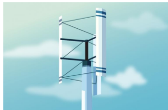
Figura 1: Imagen ilustrativa de una turbina eólica tipo Darrieus
