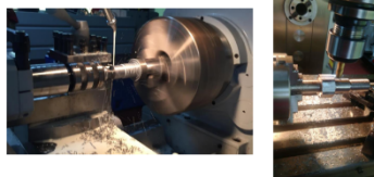
Figura 1: Operaciones de torneado y fresado en una barra de acero SAE 1020.
