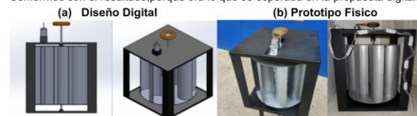
Figura 4. Diseño físico y digital de aerogenerador eléctrico.
