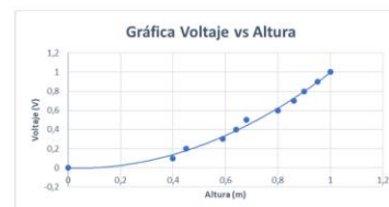
Figura 3. Gráfico de la variación del voltaje cuando se aumenta la altura, en la cual se puede demostrar que a medida que se aumenta la altura a la cual es liberado el fluido, aumenta la energía la cual está representada por el voltaje medido.
