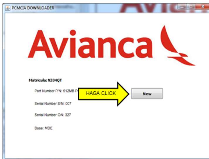
Figura 9. Aplicación PCMCIA DOWNLOADER, Nueva descarga.
