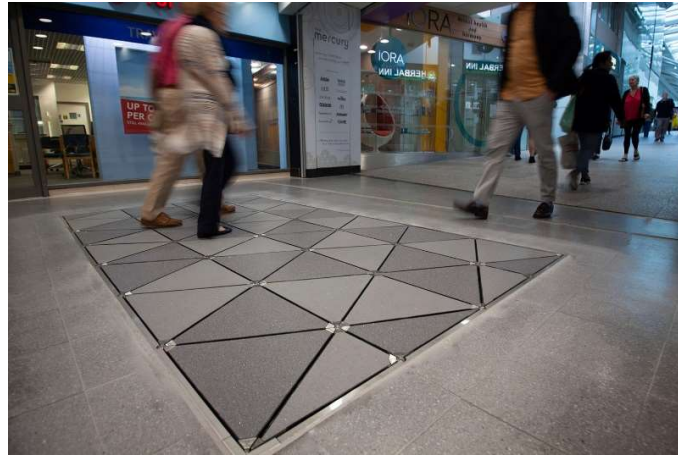
FIGURA 7: Dispositivo Piezoeléctrico instalado en Londres por Pavegen System [11]. Fuente: recuperado de: http://www.pavegen.com/mercury-mall
