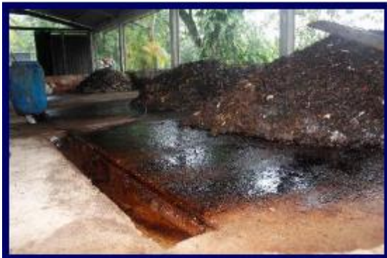
Imagen14 Camas de compost y tanque de recolección de lixiviados
