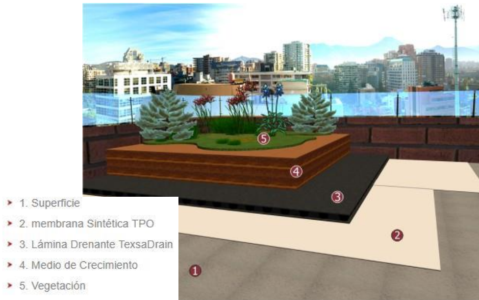
Figura 79: Detalle cubierta sistema roof garden: Detalle cubierta con sistema de impermeabilización:
