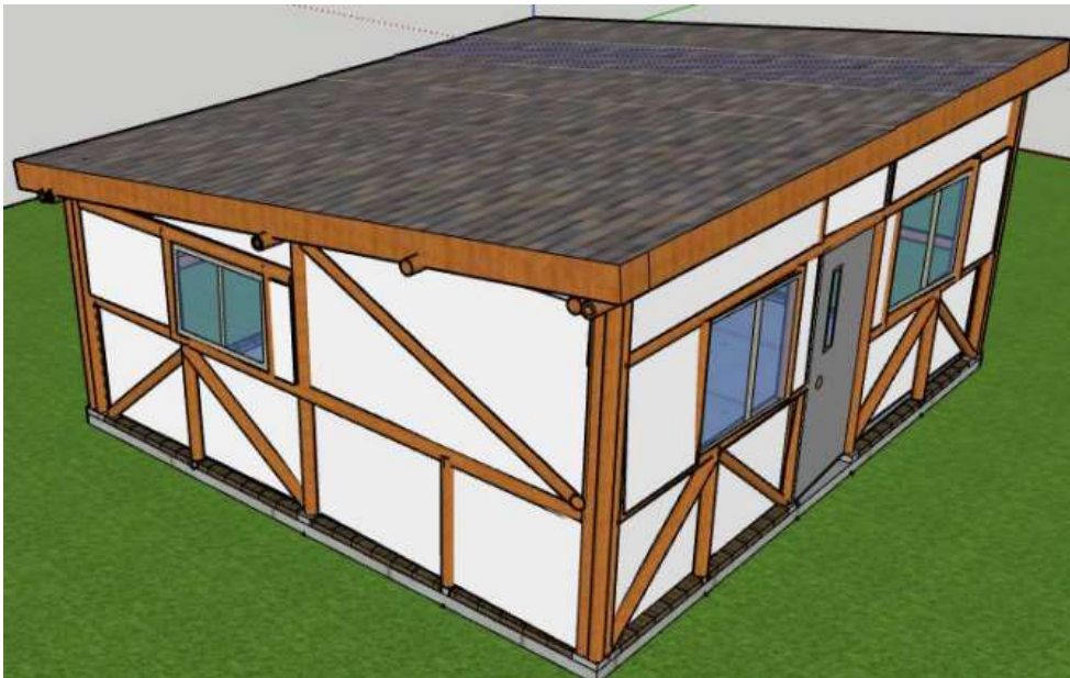
Figura 2 Diseño de la vivienda en Guadua Vista 3D SketchUp
