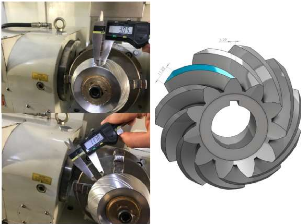
Figura 51 verificación del ancho del diente en la cara superior como externo e interno
