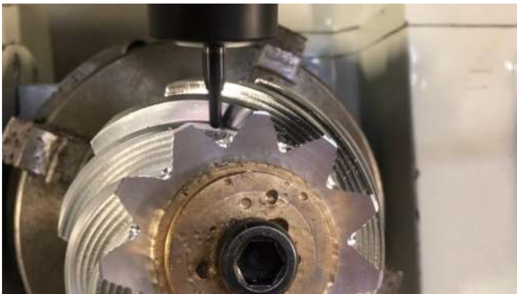
Figura 54. Vista frontal de la herramienta con respecto a la superficie del diente "ángulo de inclinación tilt"
