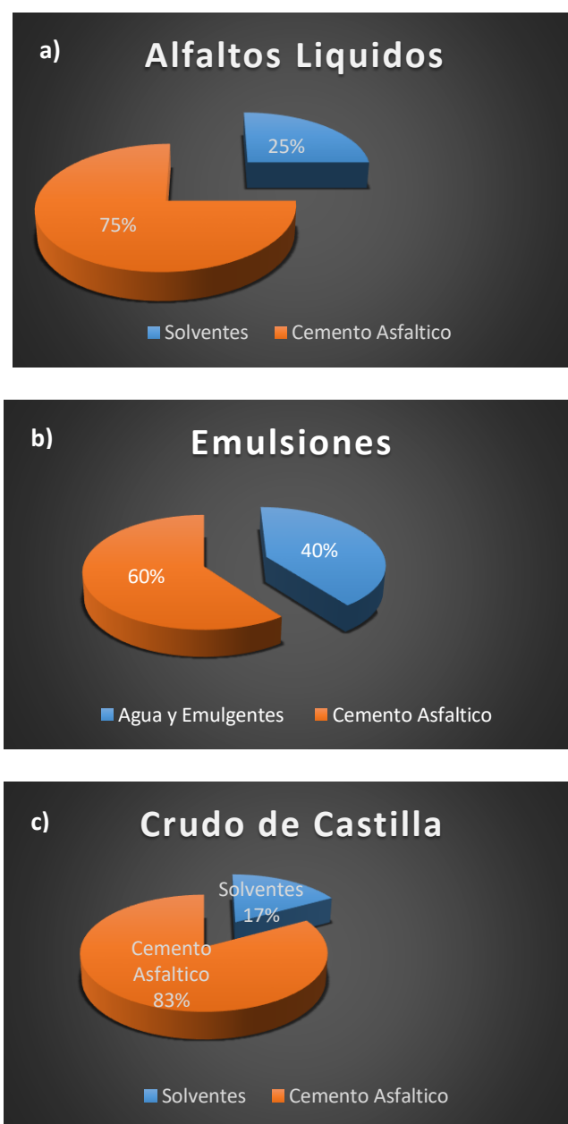
Figura 1. Representación esquemática de los productos asfálticos líquidos.
