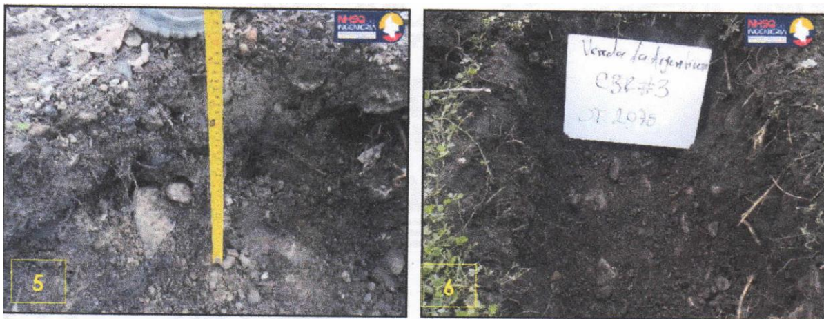
Fotografía 7. Toma de Muestra para CBR No 3. Vereda La Argentina.
