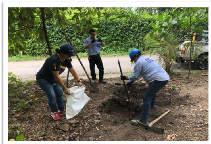
Fotografía 9. Realización del segundo apique y toma de muestra. Vereda La Argentina.
