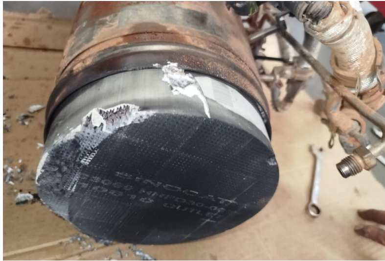
Figura 49 Filtro DPF averiado en vehículo Forland LHR DC.
