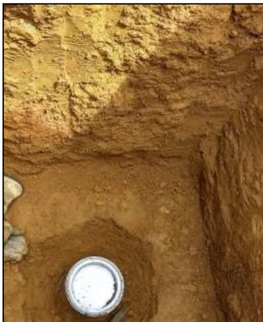
Figura 9-2. Toma de muestra inalterada – CBR Fuente: Autores
