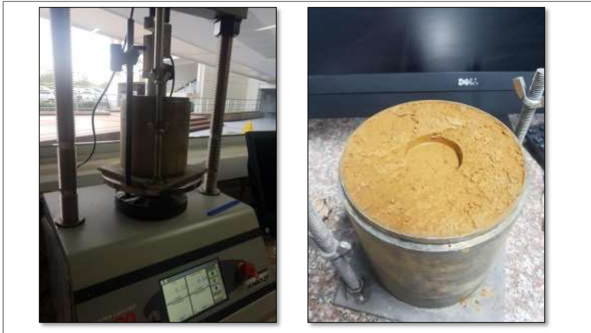
Figura 9-9. Aplicación de la carga – Muestra inalterada. Fuente: Autores.
