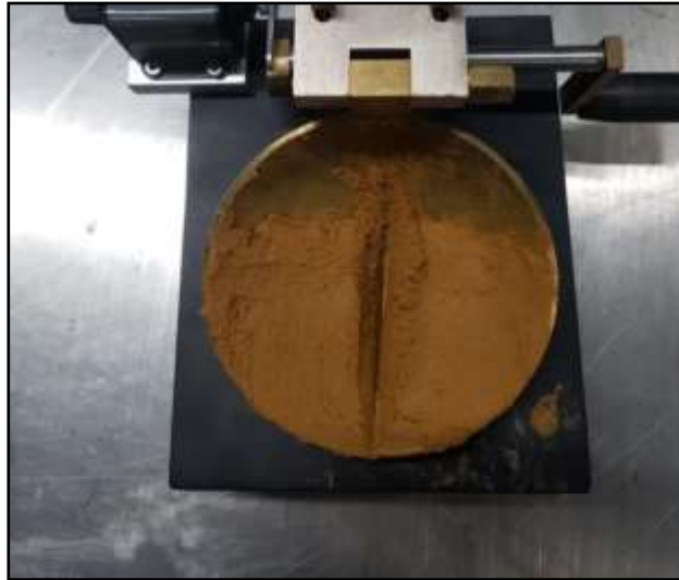
Figura 9-5. Limite Liquido - Cazuela de Casagrande Fuente: Autores
