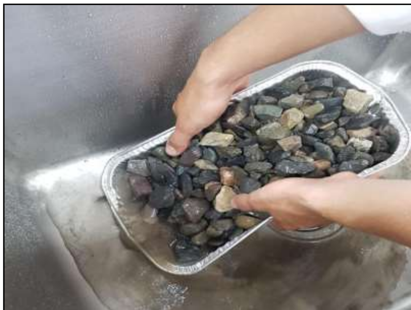
Figura 10-18. Lavado de Material de Río. Fuente: Autores
