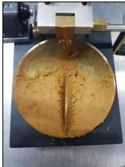
Figura 9-4. Limite Liquido - Cazuela de Casagrande. Fuente: Autores.
