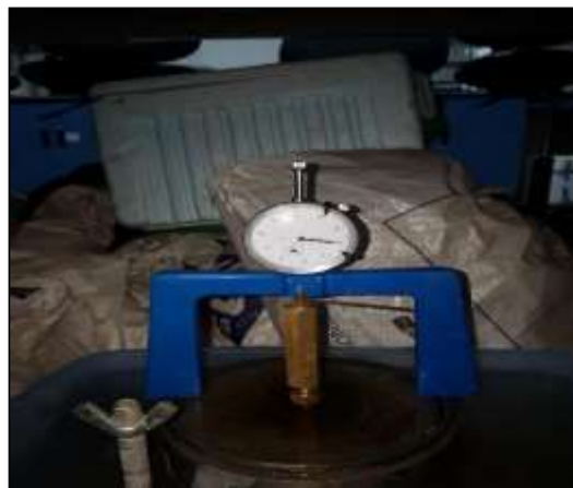
Figura 9-8. Molde CBR sumergido – Muestra inalterada. Fuente: Autores.
