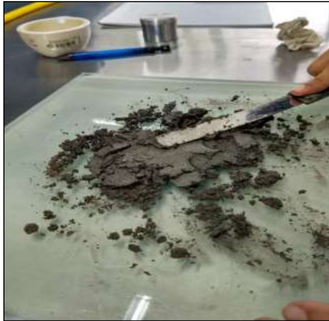
Figura 10-4. Limite Liquido - Material crudo de Rio. Fuente: Autores
