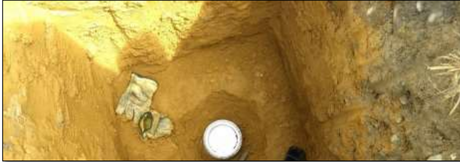
Figura 9-7. Obtención muestra inalterada – material existente. Fuente: Autores.
