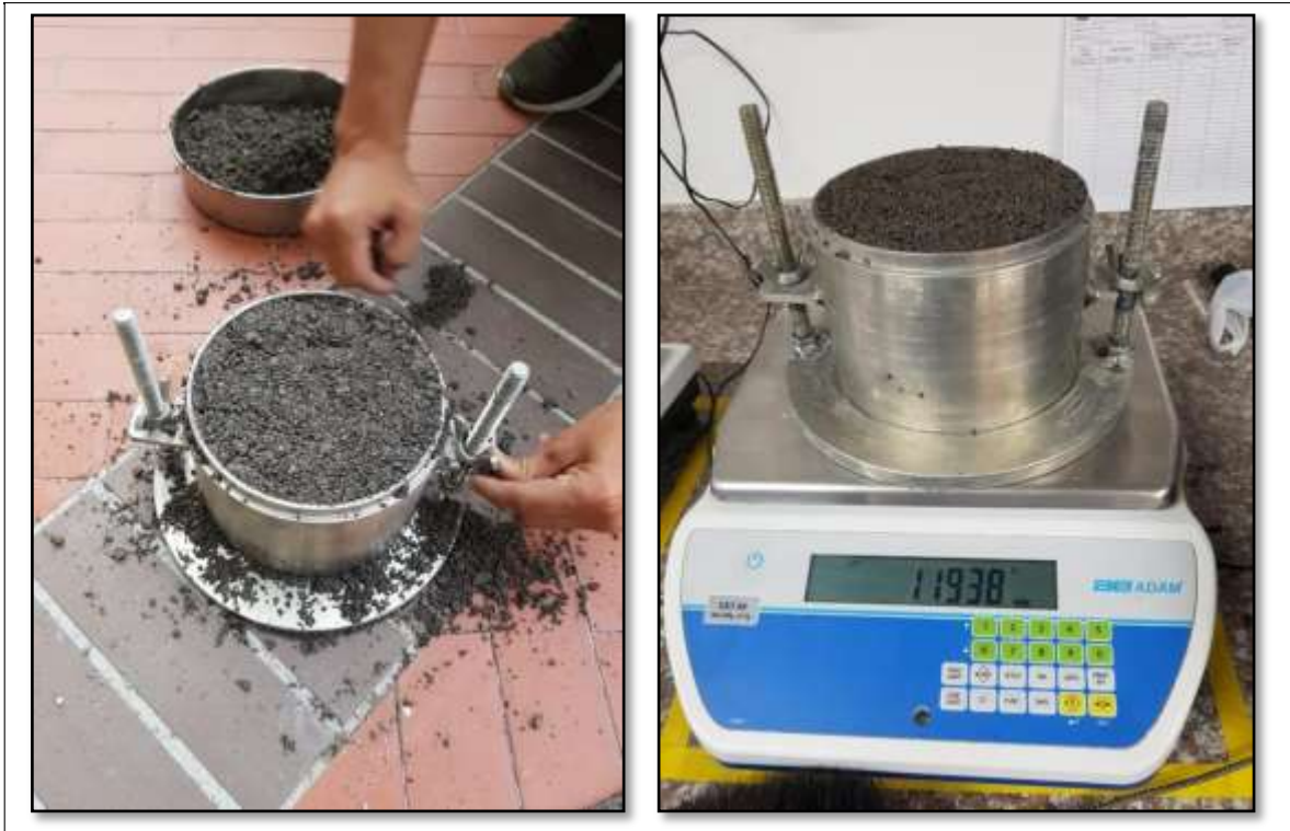
Figura 10-9. Muestra Proctor Modificado. Fuente: Autores
