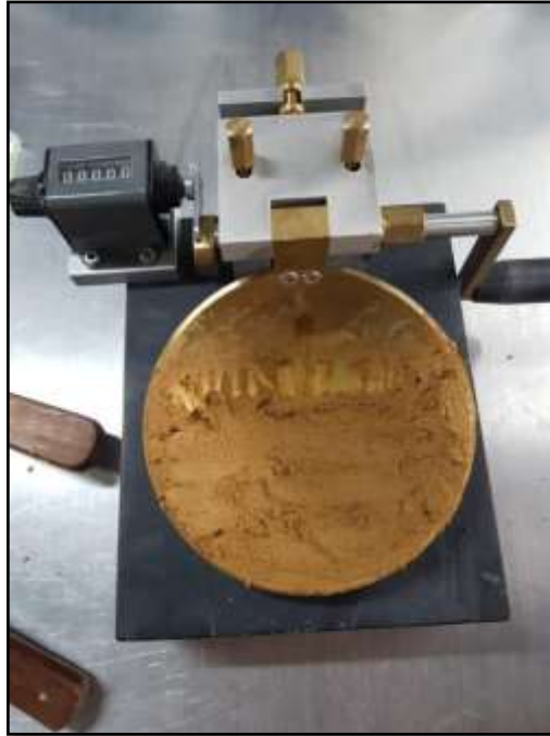
Figura 9-3. Limite Liquido - Cazuela de Casagrande. Fuente: Autores.
