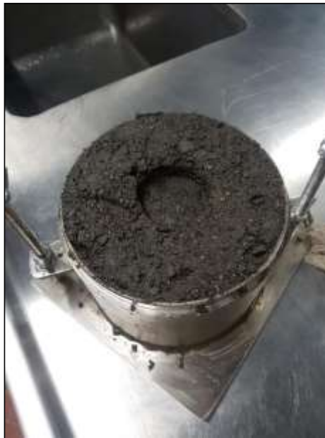
Figura 10-12. Aplicación de carga (CBR) material de río. Fuente: Autores
