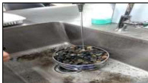
Figura 10-13. Lavado de material de Río.
