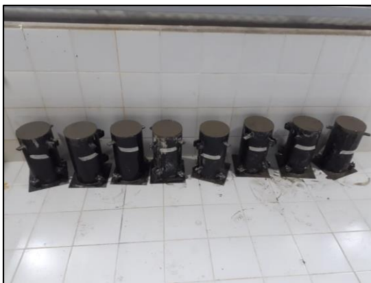
Fotos 6 y 7. Cilindros de concreto y tubos para prueba de corte. Fuente. Autor.
