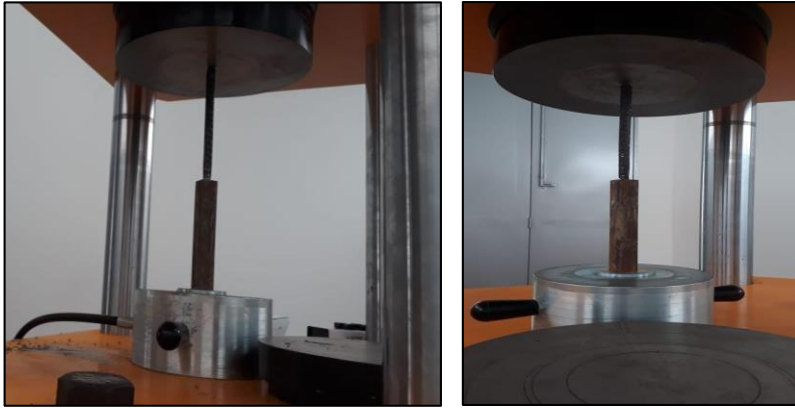
Fotos 15 y 16. Resistencia por adherencia directa. Fuente. Autor
