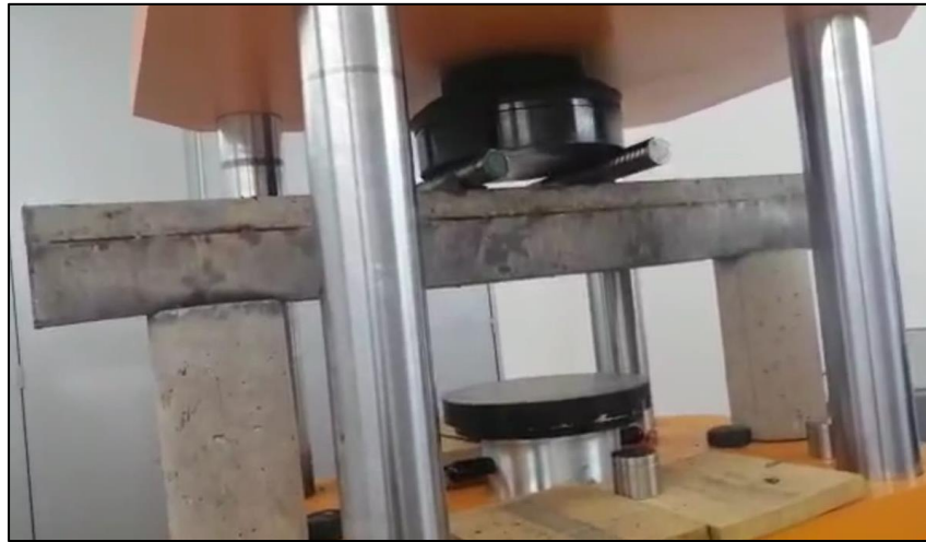
Foto 11. Cilindros de concreto y tubos para prueba de corte. Fuente. Autor
