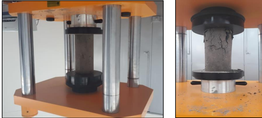
Fotos 8 y 9. Cilindros de concreto y tubos para prueba de corte. Fuente. Autor
