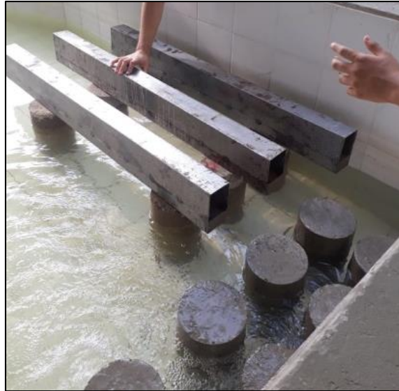
Foto 5. Fraguado de la sección compuesta. Fuente. Autor.
