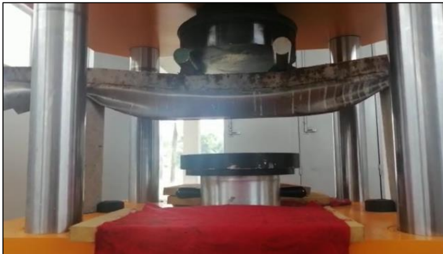
Foto 12. Falla de la sección compuesta. Fuente. Autor
