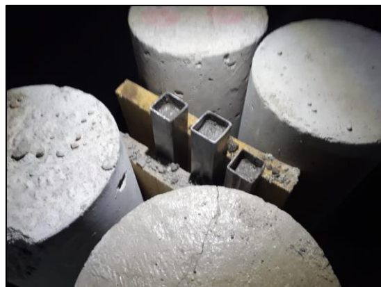
Fotos 6 y 7. Cilindros de concreto y tubos para prueba de corte. Fuente. Autor.
