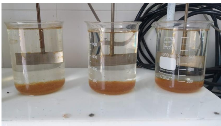
Ilustración 15. Ensayo de jarras en el laboratorio de la PTAP con cloruro férrico como coagulante
