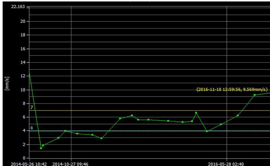
Figura 20. Análisis de tendencia Motor Ventilador aire combustión en Barth (D).
