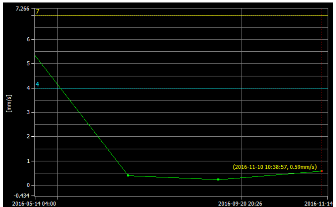
Figura 37. Análisis de tendencia Bomba calderas en Servicios Industriales (A).
