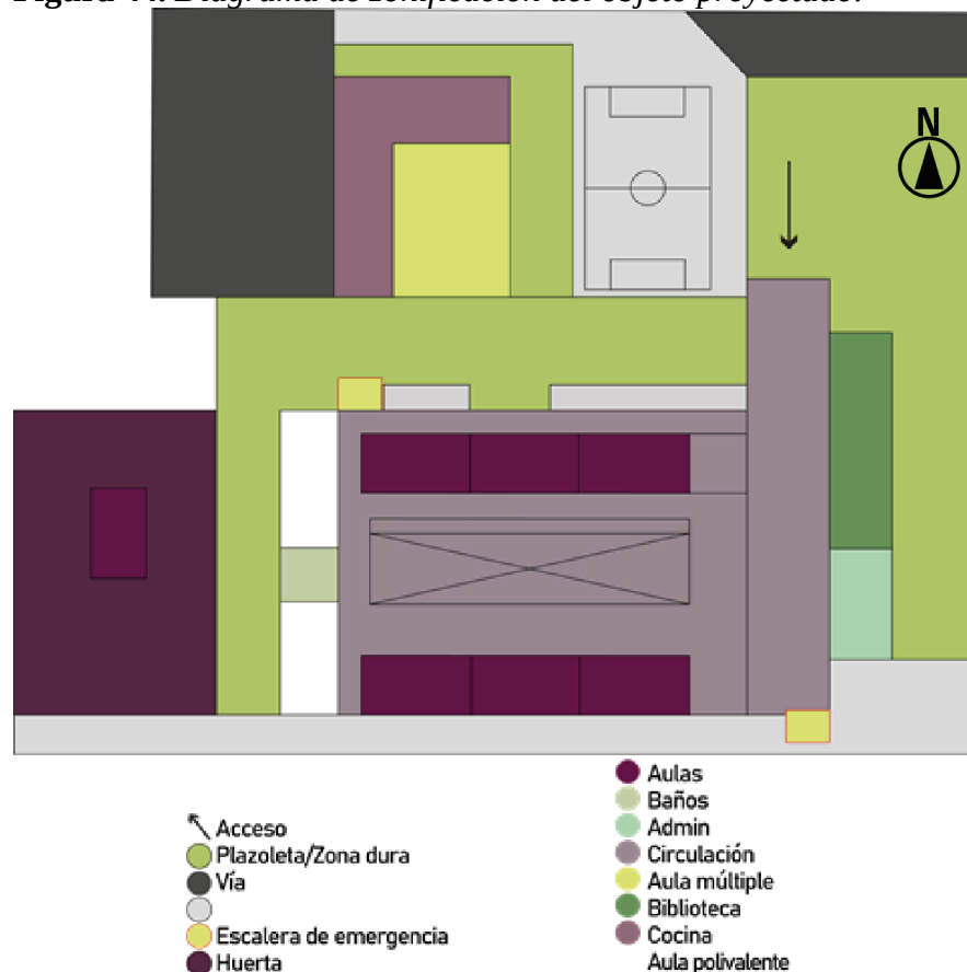
Figura 44. Diagrama de zonificación del objeto proyectado.
