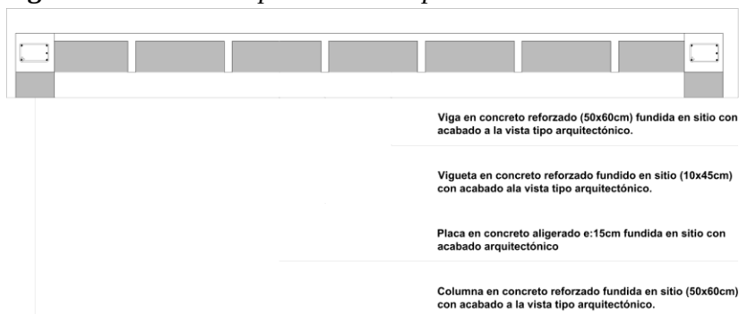
Figura 51. Detalle de placa de entepiso.
