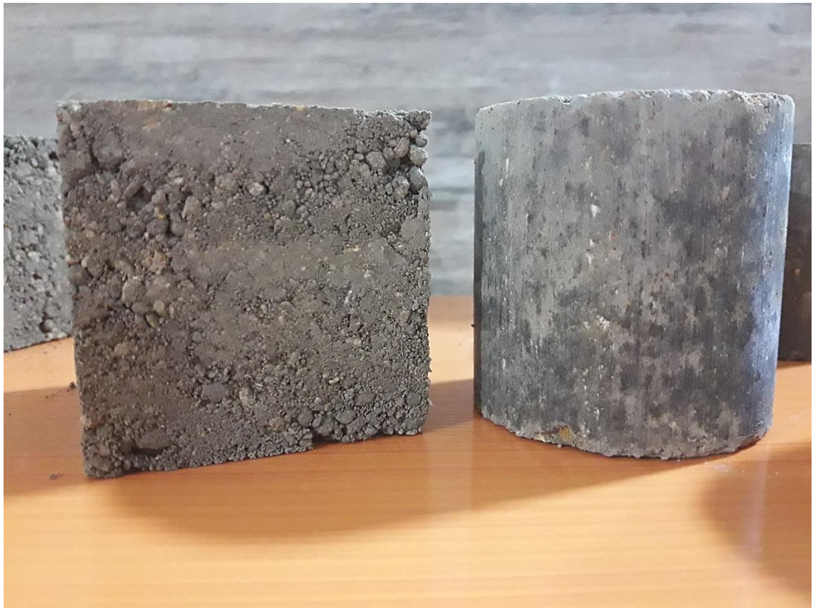
Figura 51. Muestras de suelo cemento equivalentes a los cubos de mortero
