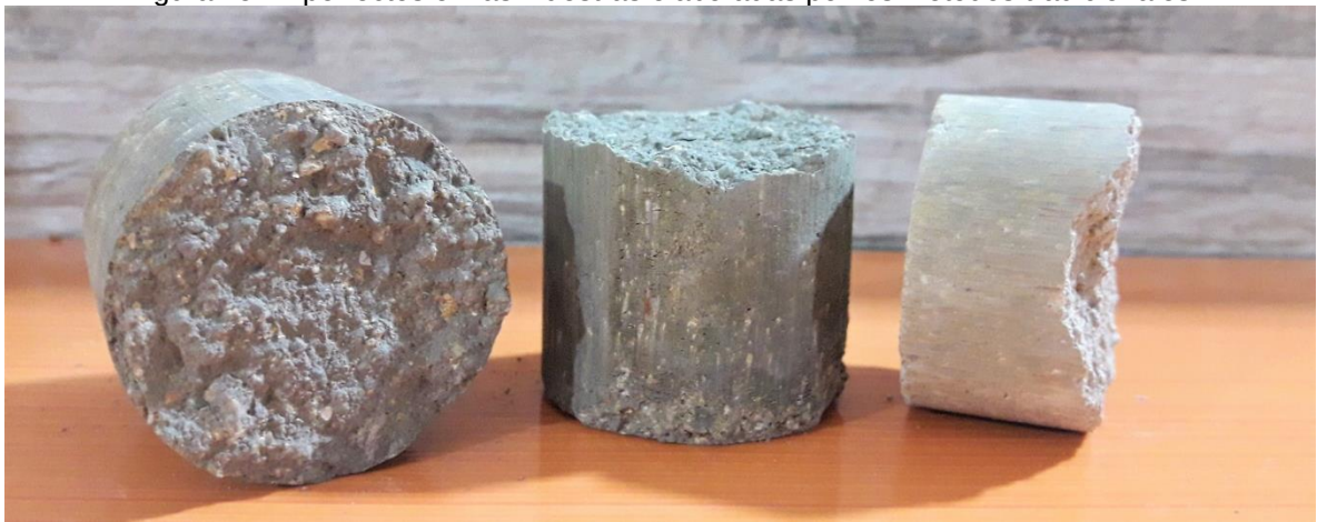
Figura 45. Imperfectos en las muestras elaboradas por los métodos tradicionales
