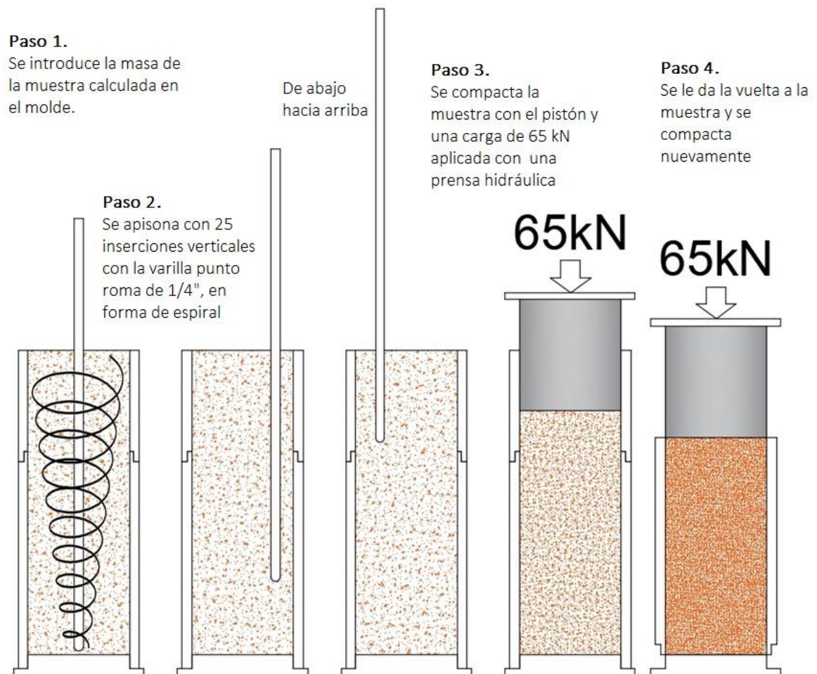
Figura 79. Proceso de compactación de las muestras de suelo cemento
