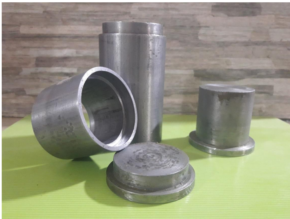
Figura 89. Molde de acero maquinado para elaborar las muestras para Módulo resiliente
