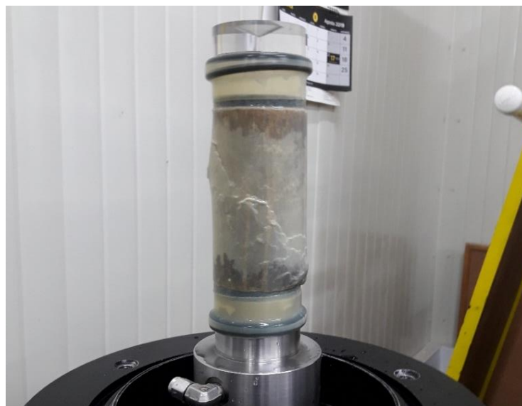
Figura 92. Falla transversal de la muestra sometida a cargas cíclicas y esfuerzo Triaxial.
