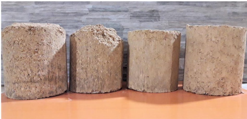
Figura 44. Muestras cilíndricas compactadas por el método diseñado por los autores
