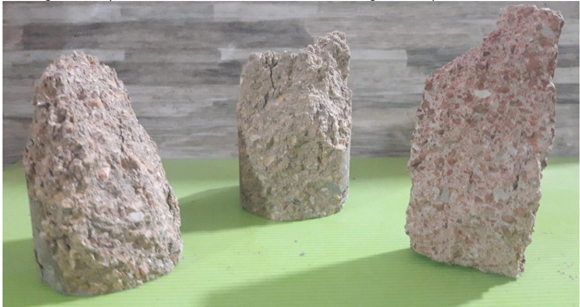
Figura 83. Tipo de falla de las muestras sometidas a carga de compresión confinada
