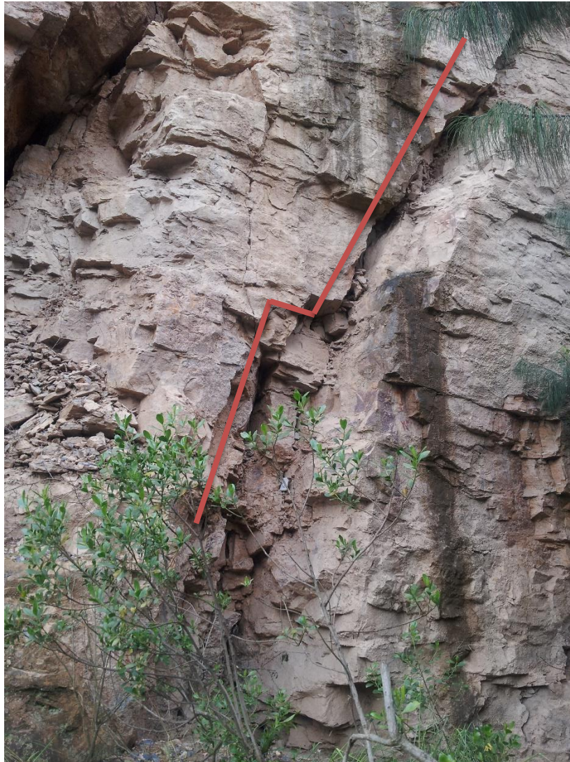
Figura 45. Forma y continuidad, Escalonada rugosa. Cantera de San Antonio Norte. Zona 2
