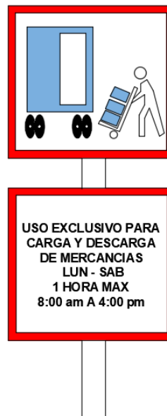
Figura 24. Señalización vertical propuesta e implementada en modelo
