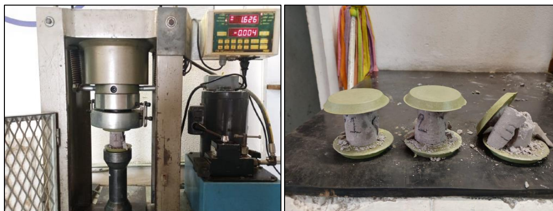
Ilustración 26. Fallo a compresión de núcleos
