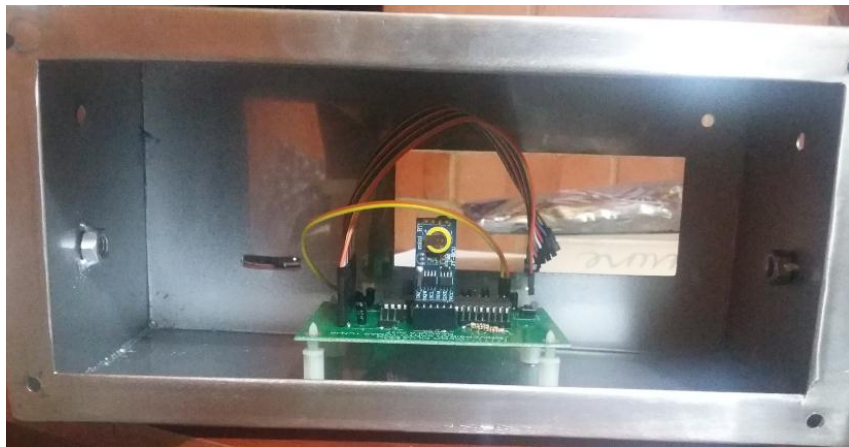
FIGURA 67. Montaje de los circuitos a la caja
