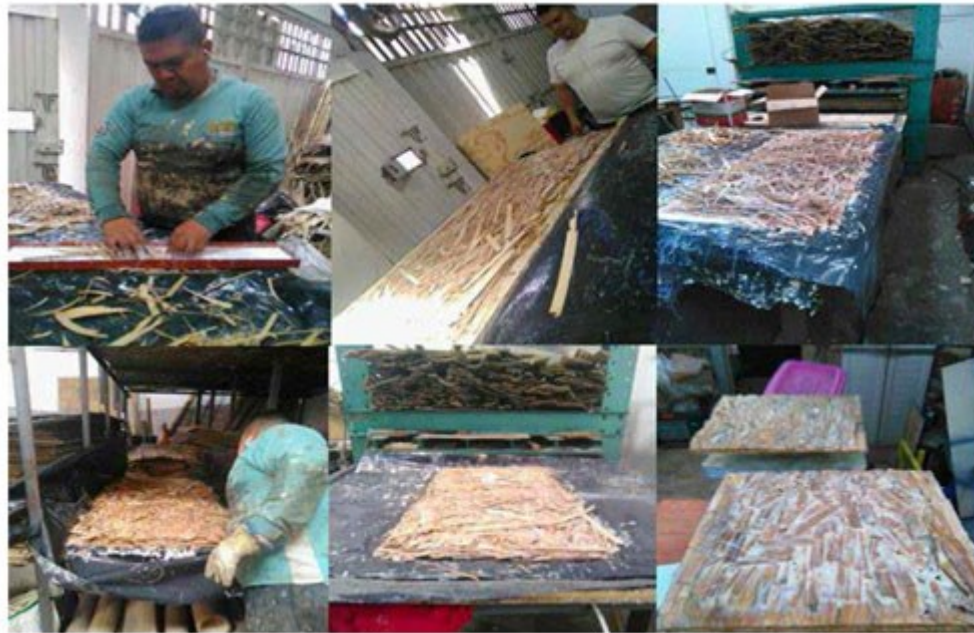
Figura 39. Fabricación de láminas para muros con hojuelas de guadua
