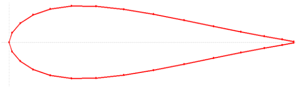
Figura 4. Perfil Aerodinámico Eppler 479 (E479). Fuente: elaboración propia.
