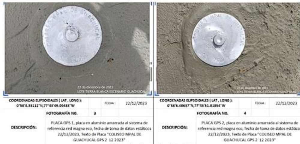
Figura 6. Puntos de georreferenciación materializados.
