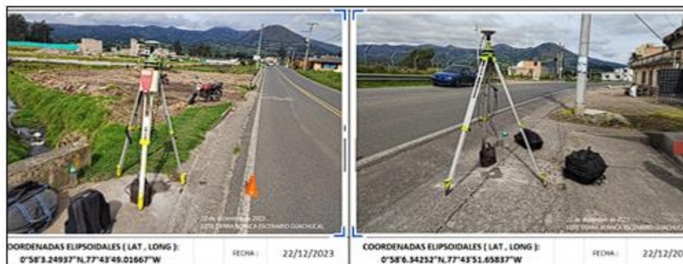
Figura 5. Rastreo de puntos de amarre GPS 1 y GPS 2 Mediante GPS de doble frecuencia
