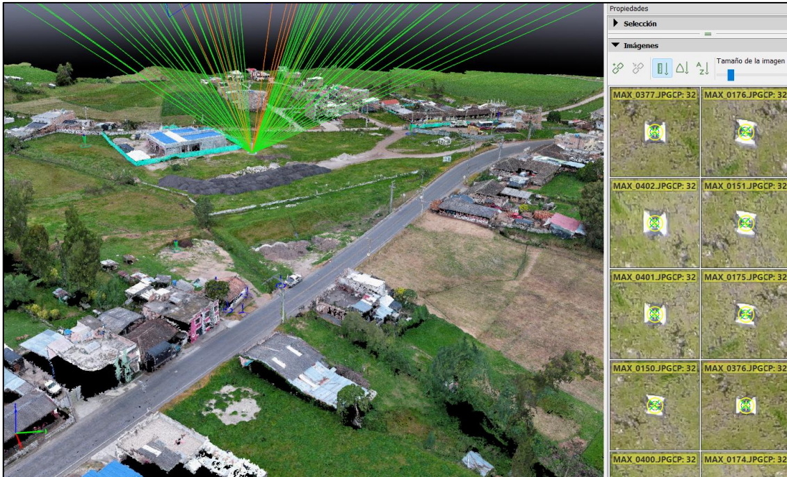
Figura 6. Marcado de puntos de control en fotografía.
