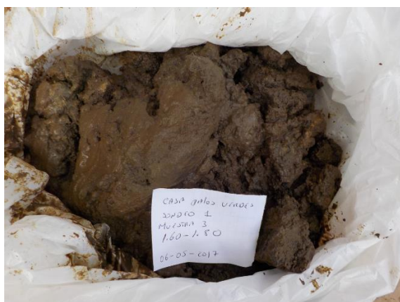
Fotografía 20: Material del apique profundidad 1.4 a 1.6 m alto humedad, alta deformabilidad. Fuente propia 2017.
