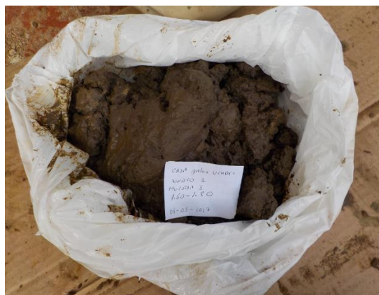
Fotografía 12 : Suelo con alto contenido de humedad y altamente deformable. Fuente propia 2017.
