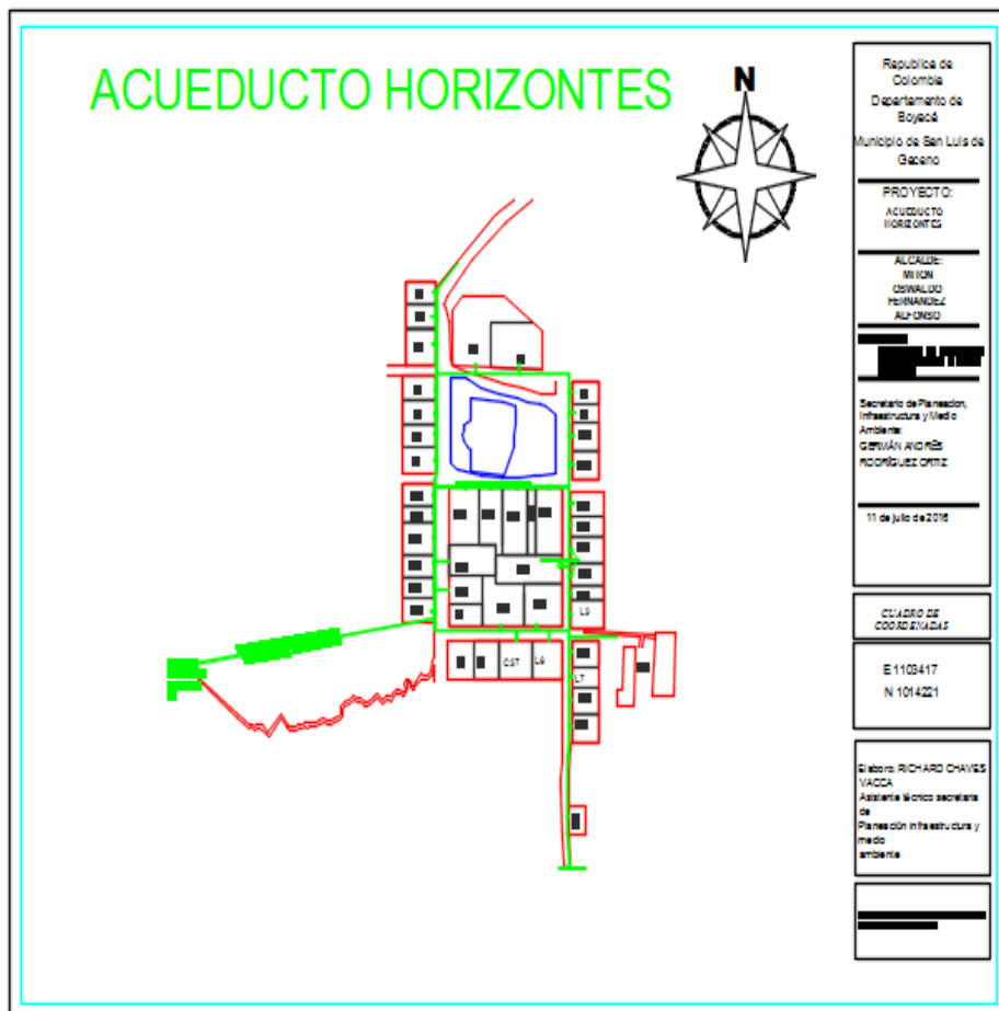
Ilustración 45: Red de Distribución Acueducto Vereda Horizontes
