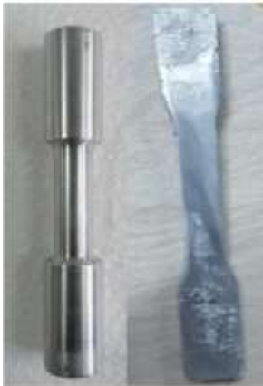
Figura 1. Probetas utilizadas para el ensayo. Autor. Propio.
