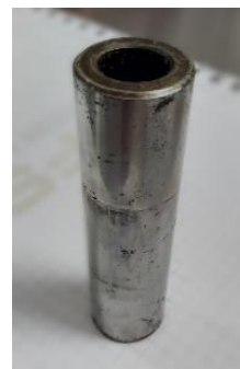
Figura 2- Bulón del cual fueron extraídas las muestras de este trabajo
