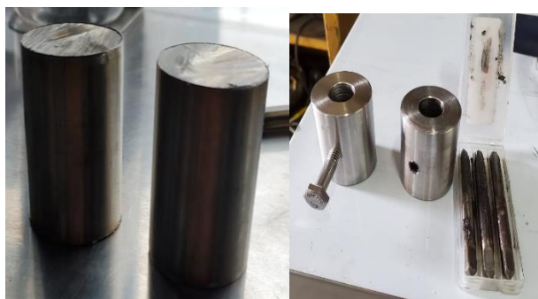
Figura 5. Maquinado de los pesos móviles.
