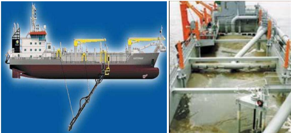
Figura 2.3 Draga de Succión en Marcha y vista de la bodega
