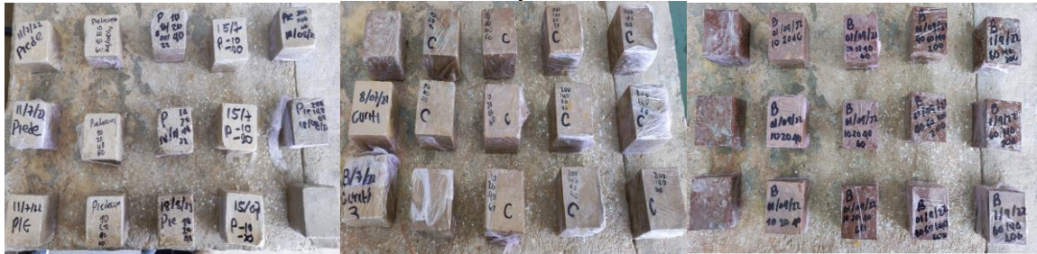
Figura 30. Periodo de Curado de 28 días de cada espécimen
