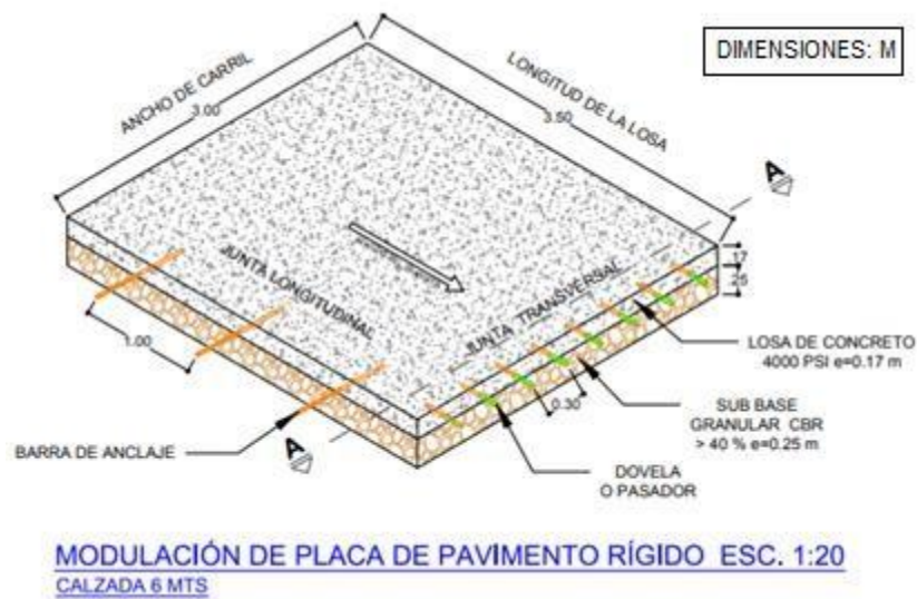
Figura 13. Detalle modulación placa de pavimento rígido
