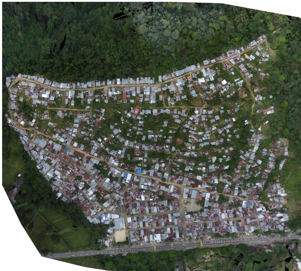
Figura 4–6 Archivo .tif generado por el procesamiento de la totalidad de fotografías capturadas por el dron, mediante el software Pix4D Mapper. Fuente: Propia
