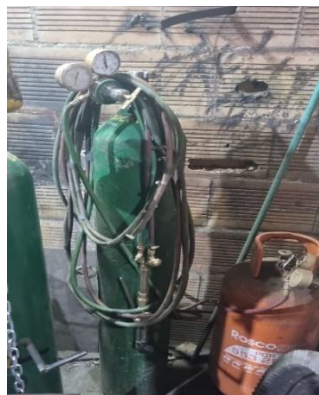
Fig. 8 Equipo de oxicorte que usa Cermac s.a.s.
