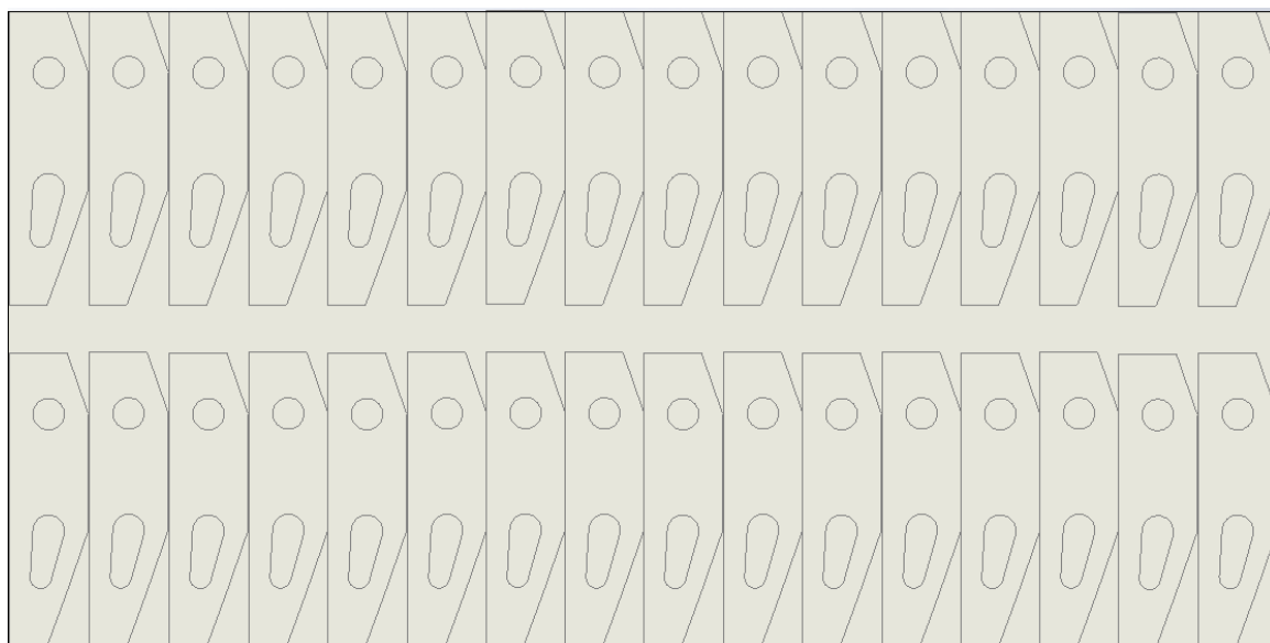
Plano 3. lámina con trazos de aspás de revolver para plasma CNC (Para 10 mezcladoras)
