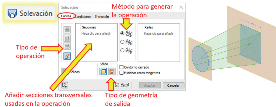
Figura 4. Icono y ventana de opciones para la herramienta solevación de Inventor®
