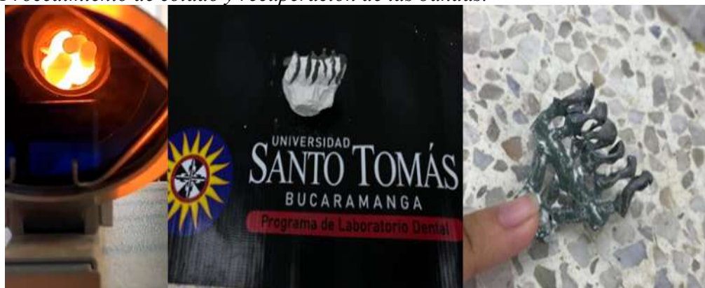
Figura 20. Procedimiento de colado y recuperación de las bandas.
