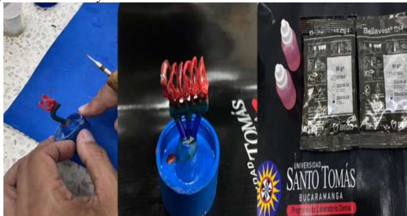
Figura 18. Montaje de bebederos y el revestimiento.
