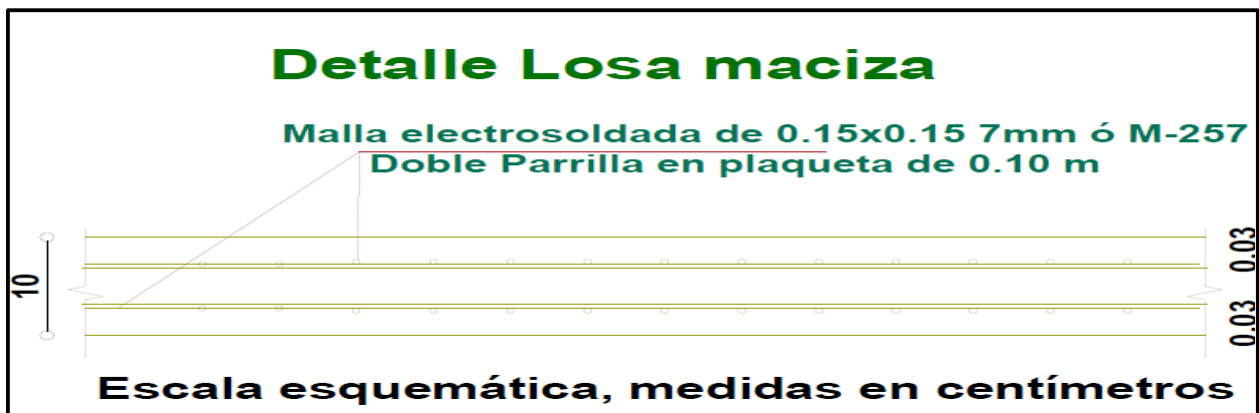
Figura 16. Detalle losa maciza, Torres del parque (Vivienda de interés prioritario).
