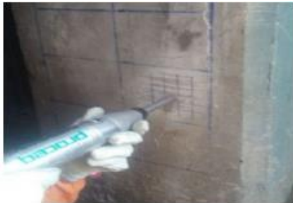
Imagen N°18 y N°19 rebote de esclerometria columna y losa primer piso
