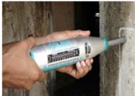
Imagen N°18 y N°19 rebote de esclerometria columna y losa primer piso
