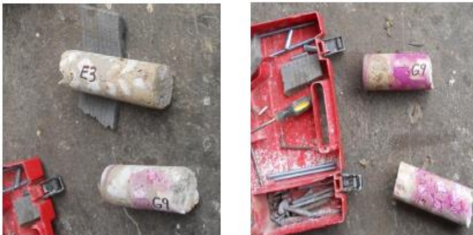
Imagen 20 y 21 especímenes, núcleos aplicando fenolftaleína
