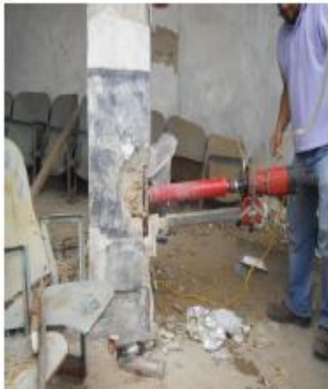
Imagen N°22 y 23 Extracción de núcleos
