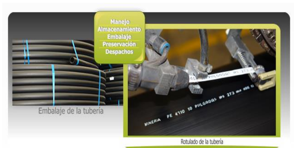
Figura 7: Embalaje y rotulado de la tubería
