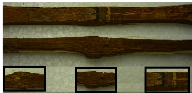
Figura 33. Cuña de falla en el nudo con un ángulo de 45° en probetas con cubiertas con C1 (Impranol), para el tiempo de exposición T1=7608 horas.
