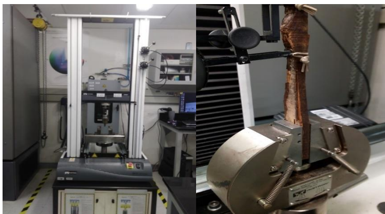
Figura 30. Ensemble del ensayo a tensión paralelo a la fibra en la máquina de prueba MTS Instron, Longitud entre mordazas oscilante entre 13 a 16 cm, deformímetro de 25 mm, duración de 3 a 10 min.
