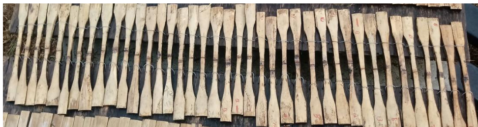
Figura 21. Especímenes de guadua en blanco (sin cubierta) con exposición T=7608 horas
