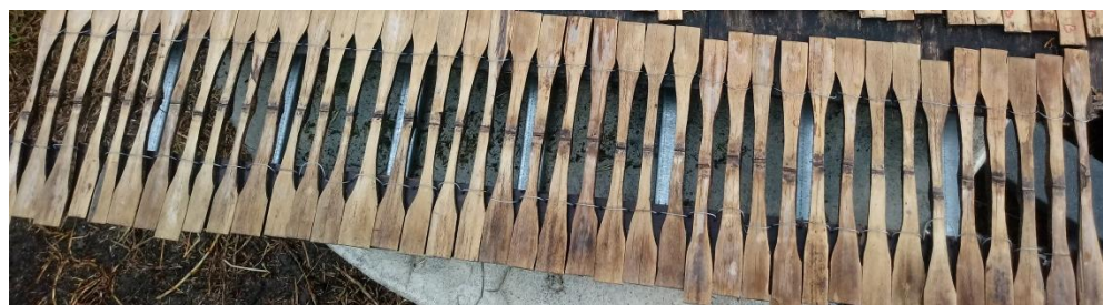
Figura 23. Probetas de guadua con cubierta C2 (Barnex) con exposición T1=7608 horas
