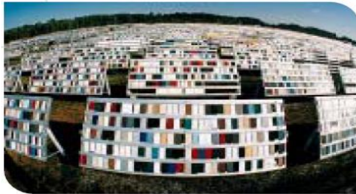
Figura 18. Muestra los tipos de estantes para pruebas de intemperismo directo.
