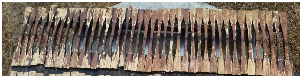
Figura 22. Probetas de guadua con cubierta C1 (Impranol) con exposición T1=7608 horas
