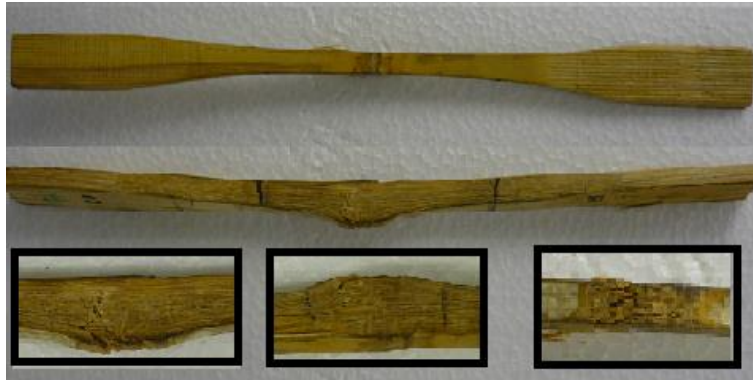
Figura 31. Cuña de falla en el nudo con un ángulo de 45° en probetas en blanco sin cubierta protectora para el tiempo de exposición T0.
