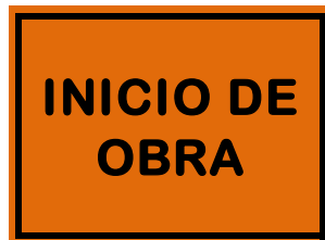
Ilustración 4 (Señal transitoria – Inicio de obra, Fuente: Manual de señalización vial).
