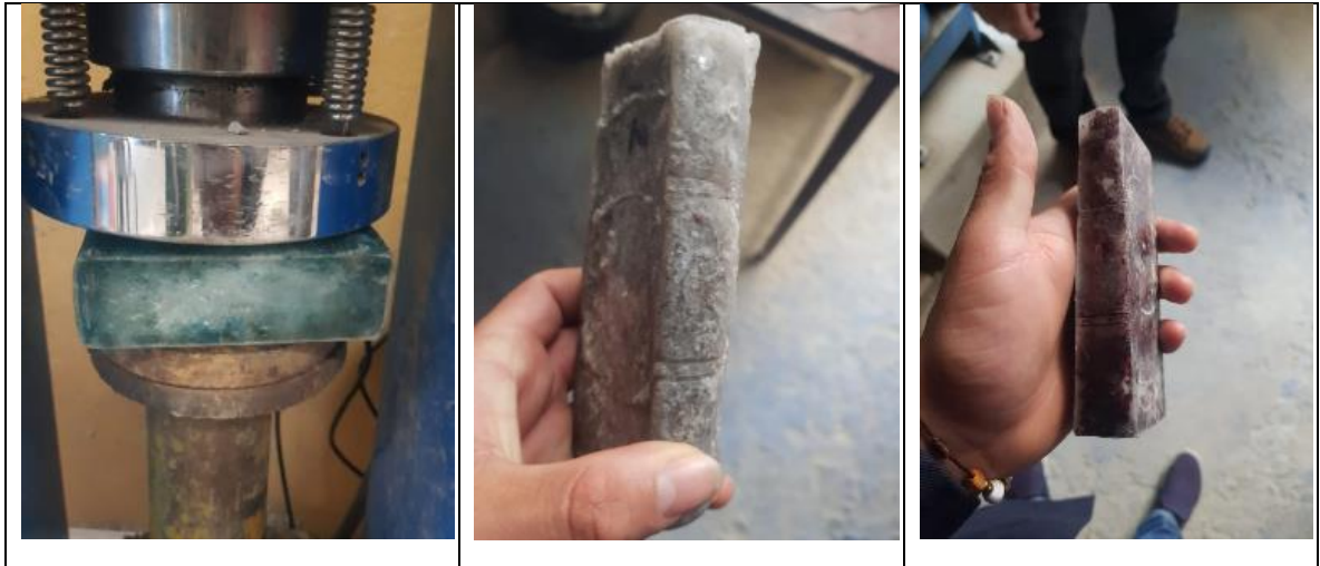
Figura 2. Resultados de la prueba de compresión
