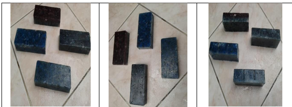
Figura 6. Resultados después de la prueba de eflorescencia
