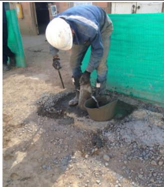
#99 Ensayo de asentamiento - CONO DE ABRAMS
