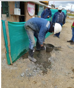
#101 Ensayo de asentamiento - CONO DE ABRAMS
