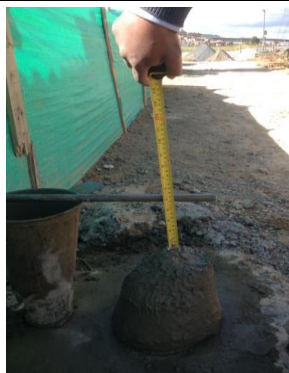
#102 Ensayo de asentamiento - CONO DE ABRAMS
