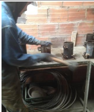
#97 Toma de muestras y ensayo de laboratorio calidad de concreto fundido en obra
