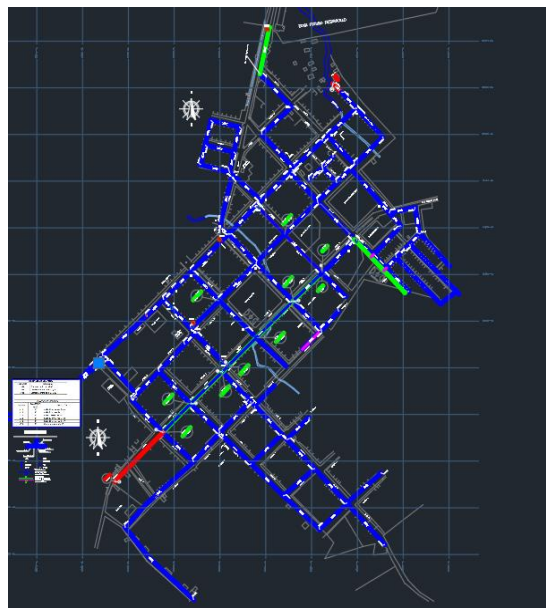
Figura 12 Plano de redes suministrado por la empresa de agua del Castillo
