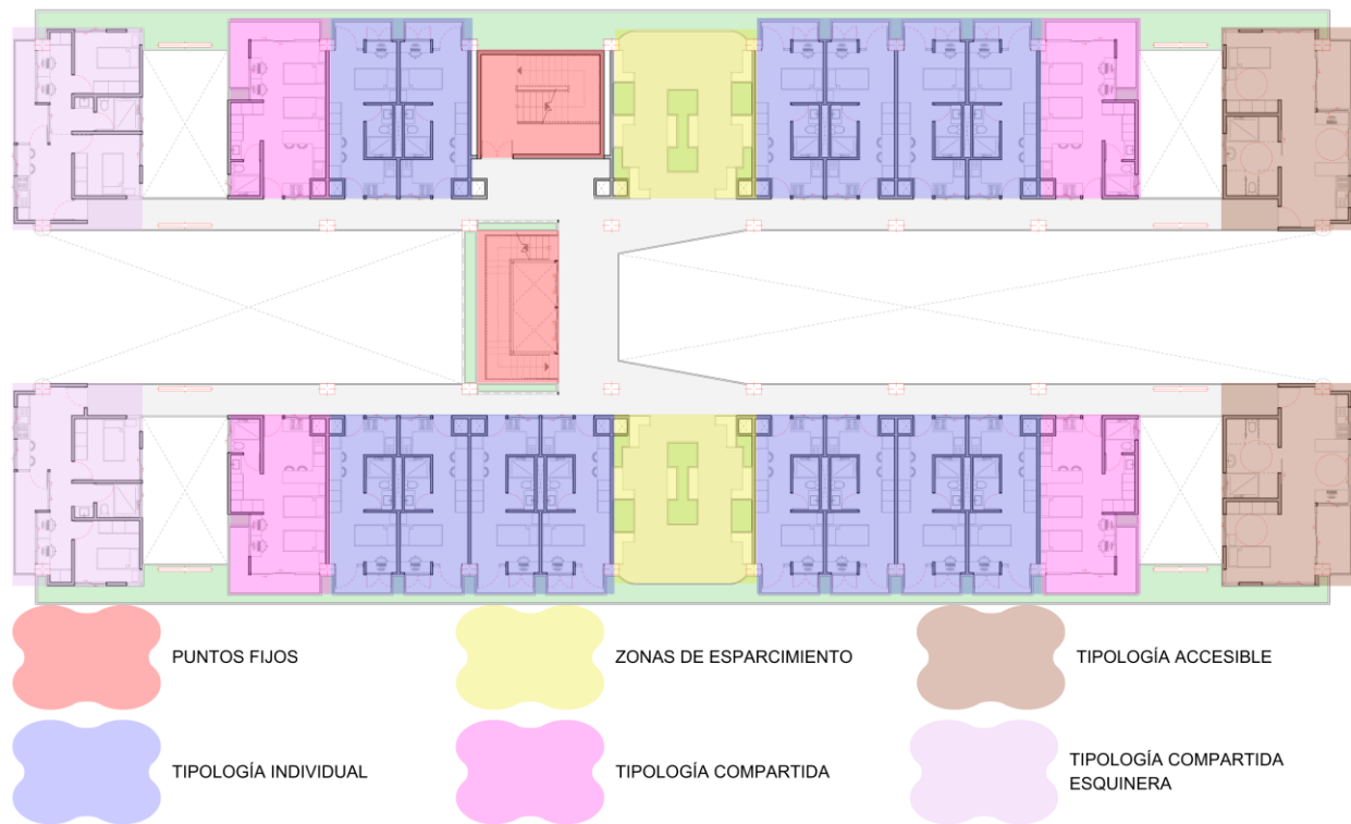
Figura 28. Plano de zonificación del Tercer piso del proyecto
