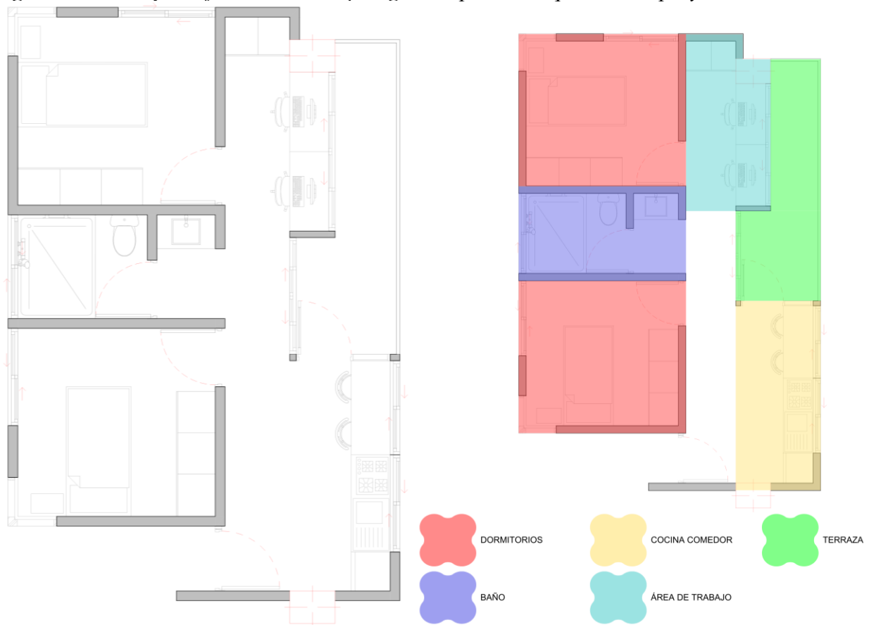
Figura 38. Plano y zonificación de la tipología compartida esquinera del proyecto
