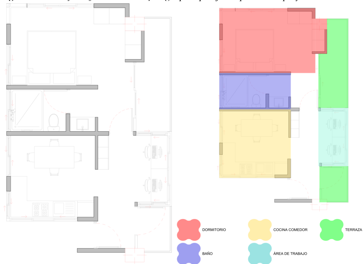
Figura 39. Plano y zonificación de la tipología para parejas esquinera del proyecto
