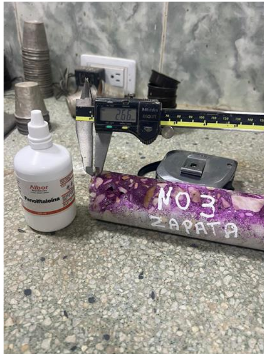
Figura 60: Carbonatación Núcleo Zapata 3 – Eje 4, Costado Sur
