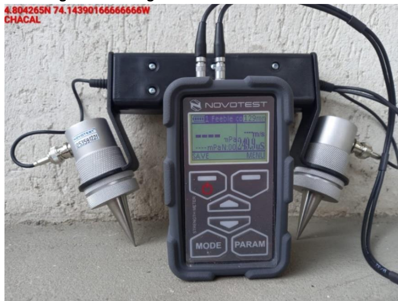
Figura 20: fotografía Ultrasonido NOVOTEST.
