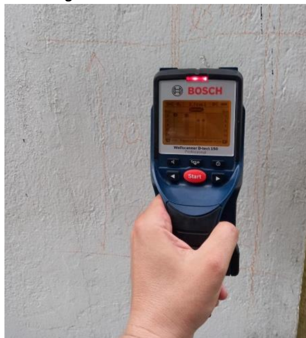
Figura 18: Scanner de refuerzo
