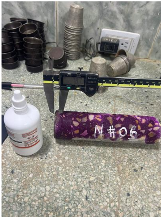
Figura 63: Núcleo Columna 2 – Eje 5, Costado Norte
