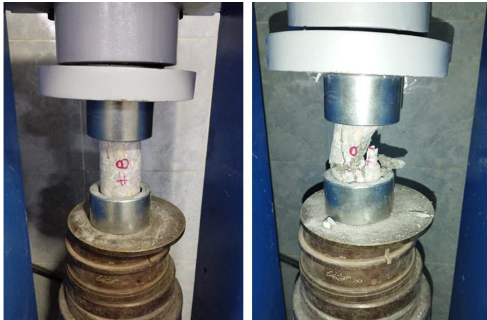
Figura 52: Núcleo Columna 1 – Eje 6, Costado Norte
