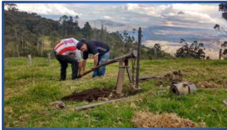
ILUSTRACIÓN 5 A) EXTRACCIÓN DE MUESTRAS PARA ESTUDIO DE SUELOS
