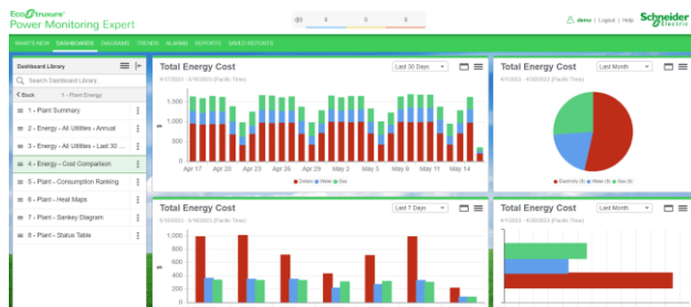
Figura 17. Dashboard simulado para el costo energético de los servicios públicos en PME. Tomado de [42].
