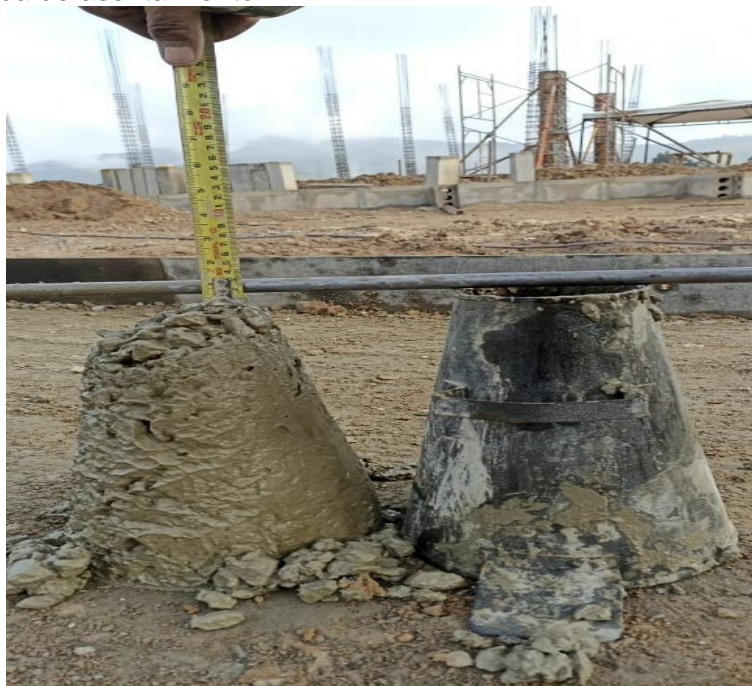
Figura 14: Prueba de asentamiento
