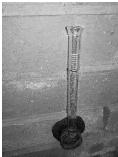
Figura 22 Evidencia fotográfica del ensayo: Zona de cavas Tubo de Karsten para ensayo de penetración: Permeabilidad muy alta.
