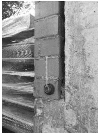
Figura 23 Evidencia fotográfica del ensayo: Zona de canastillas Tubo de Karsten para ensayo de penetración: Permeabilidad alta.
