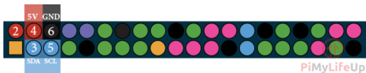
Figura 51. Detalle de la conexión RTC DS1307 a RPI 3 B+
