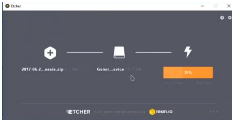
Figura 87. Instalación de la imagen de Raspbian en disco duro.
