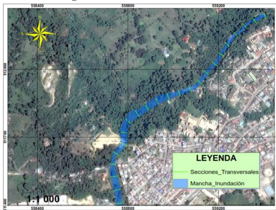
Imagen 53. Mancha de inundación tramo 1-2
