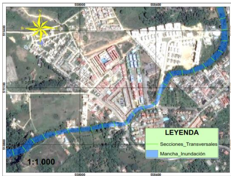
Imagen 54. Mancha de inundación tramo 2-3
