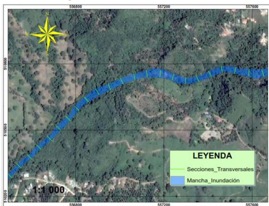
Imagen 55. Mancha de inundación tramo 3-4
