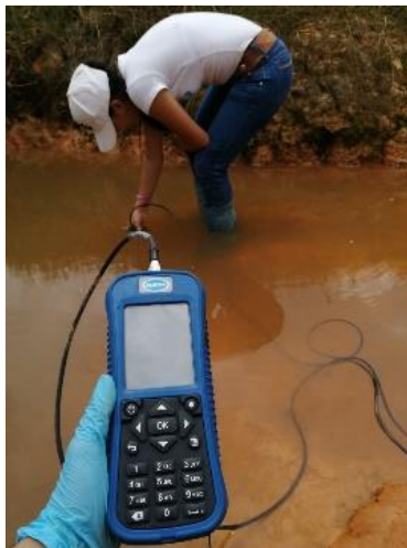
Fotografía 2. Caudalímetro para medir velocidad. Por Diego Torres; Diana Güiza, 2019.
